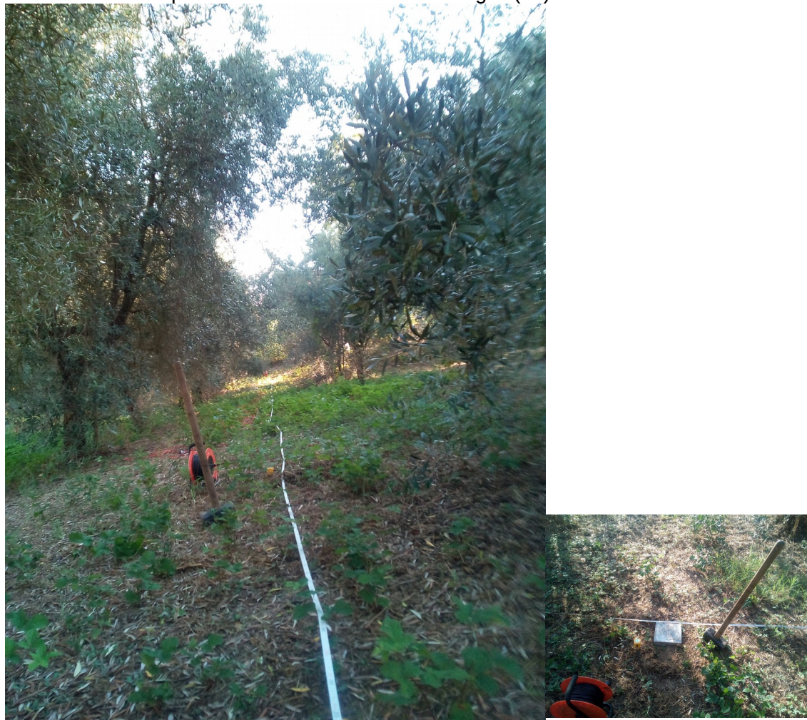
Profilo sismico MASW , visto da SW, sulla destra il sistema di energizzazione e di start
